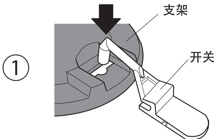
将较长的窄端插入底座的孔中。然后将其完全插入开关底座。
