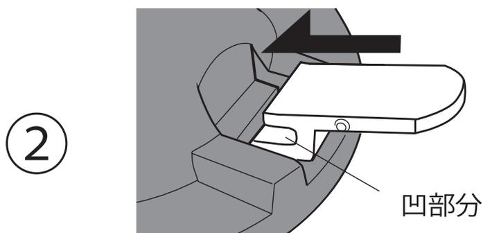
裏返して、スイッチの凹部分をホルダーの穴の図の部位にはめます。スイッチが上下に稼働することを確認してご使用ください。
