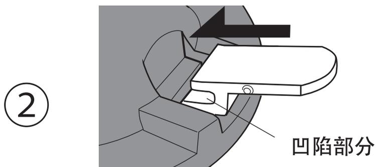
翻转后将开关安装到底座，如图所示。使用前确认开关可上下活动。
