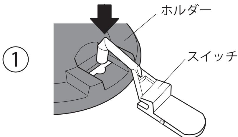
スイッチ先端の棒状の部分をホルダーの穴の中心に差し込み、そのまま柄の根元部分まで差し込みます。
